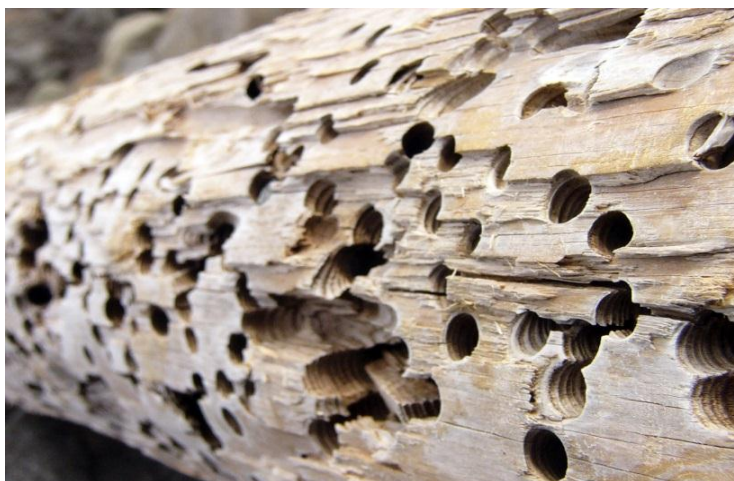
Рис.3. Поражение дерева жуками-точильщиками
