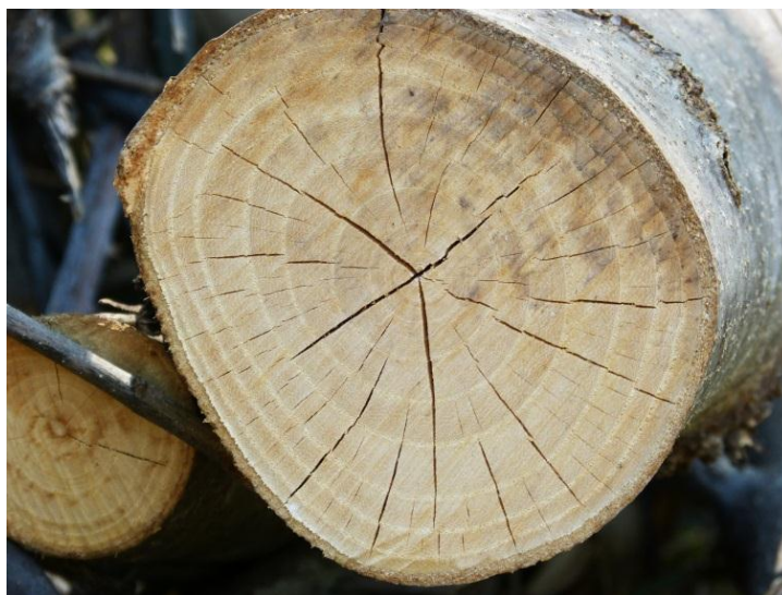
Рис.8. Трещины на годичных кольцах (чеки)
