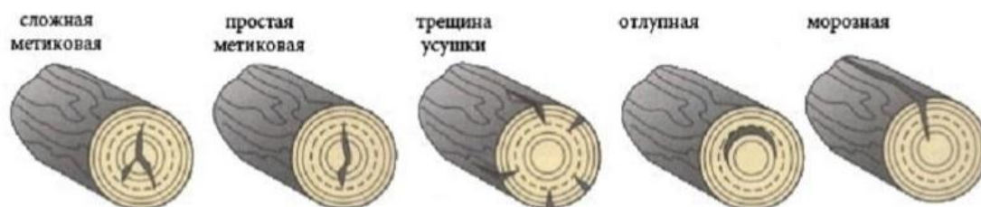
Рис.6. Виды трещин в древесине
