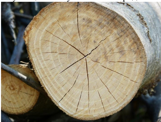
Рис. 10 Пример механического недостатка
