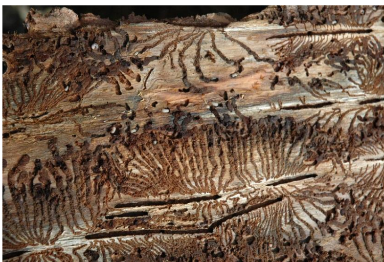
Рис.4. Поражение дерева жуками-точильщиками
